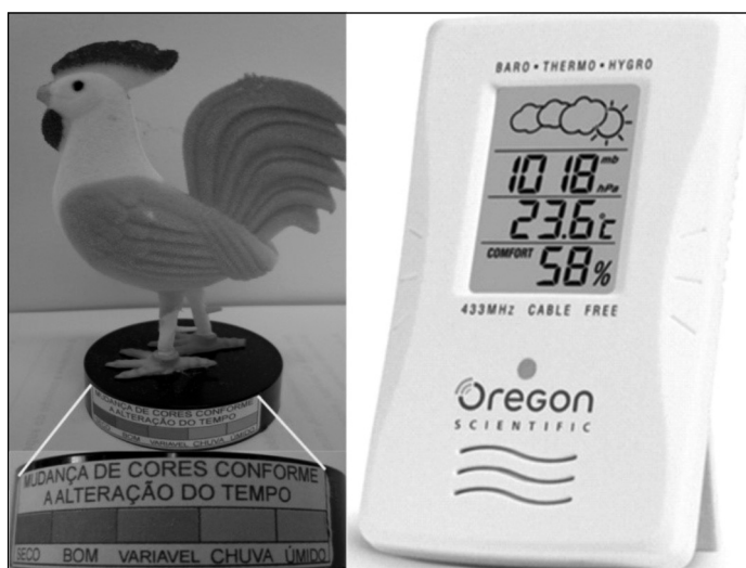
Figura 4 - Galinho do tempo e o baro-termo-higrômetro utilizados nas oficinas
