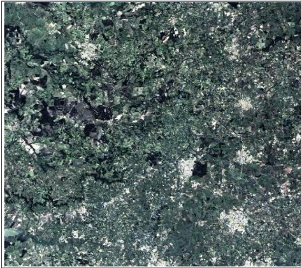
Figura 5 – Cena de satélite LANDSAT na composição 3R2G1B, tratada com Realce de Contraste por Equalização de Histograma. LANDSAT, 2000.
