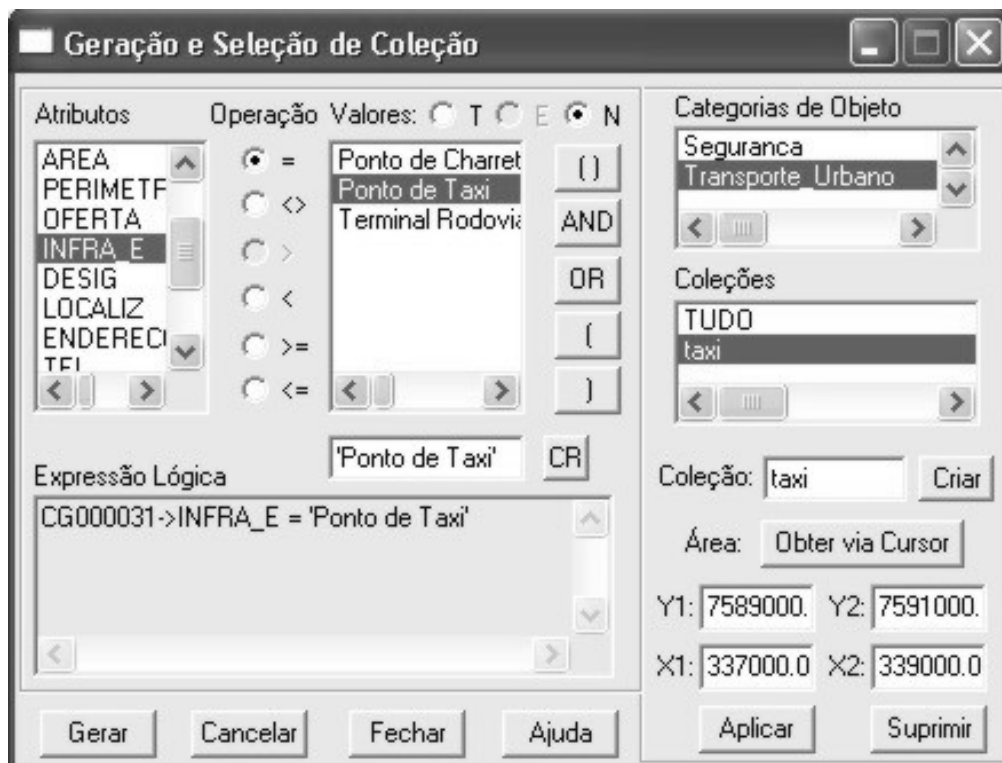
Fig. 9a - Tela de geração e seleção de coleção. A categoria “transporte urbano” foi selecionada, a coleção “táxi” foi criada, o atributo INFRA_E foi selecionado e o valor T” foi marcado.
