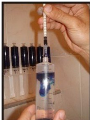
Foto 08: Adição do Azul de Metileno à amostra de água. Foto: Monteiro, A. B. (28/12/07).
