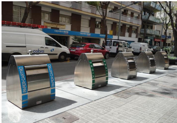
Figura 4 - Containers com armazenamento subterrâneo de resíduos na cidade de Cerdanyola del Valles – Província de Barcelona
