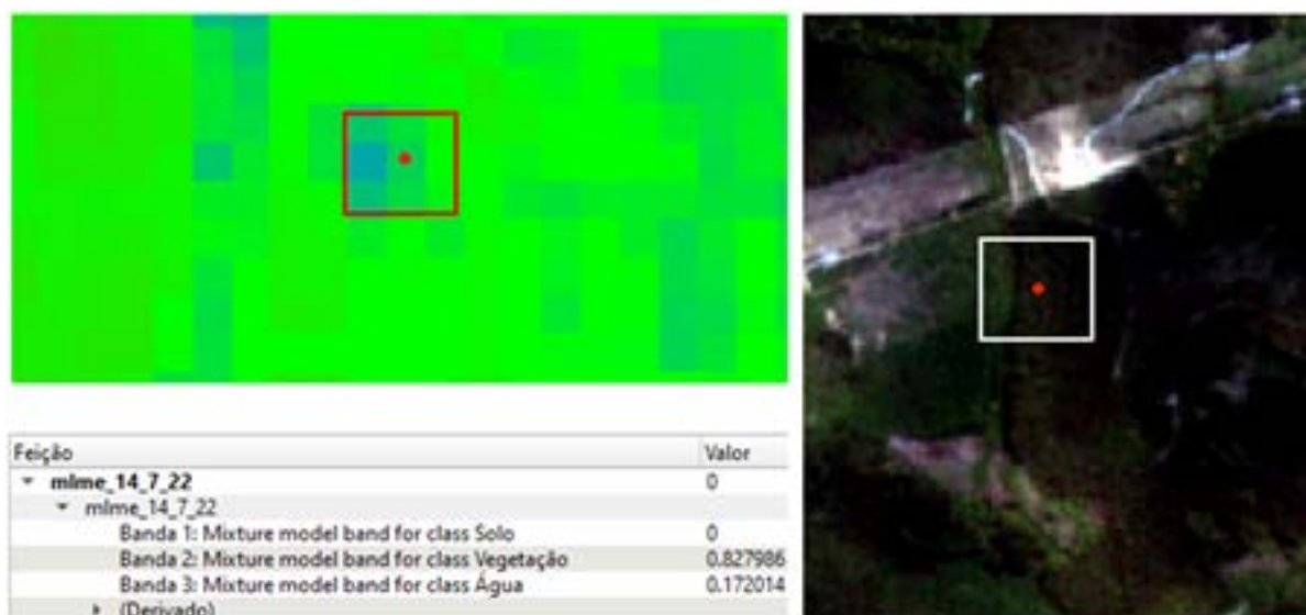
Figura 11 - Seleção de um pixel em área de floresta plantada para observação do efeito de mistura sendo obtidas frações de vegetação (0,83) e de sombra (0,17).
