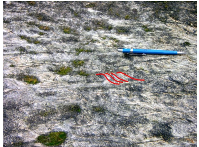
FIGURA 10. Arenito com laminação cruzada clino-ascendente (Sr) (ponto 19).
