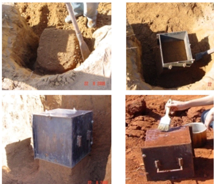
FIGURA 5. Coleta de amostra inderformada (escavação e selamento).
