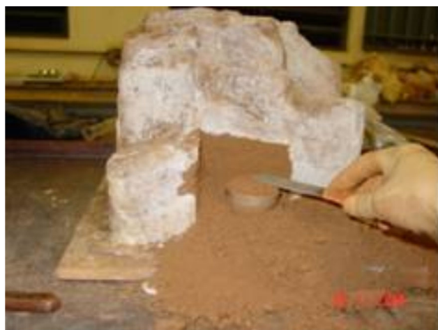
FIGURA 13. Moldagem dos cp's.
