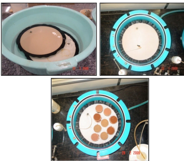
FIGURA 12. Sequência do ensaio (saturação; montagem do equipamento; amostras sobre a placa).
