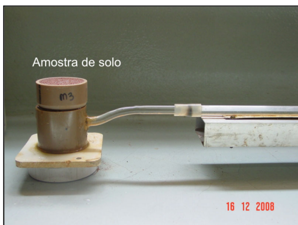
FIGURA 16. Detalhe da amostra sobre a pedra porosa.
