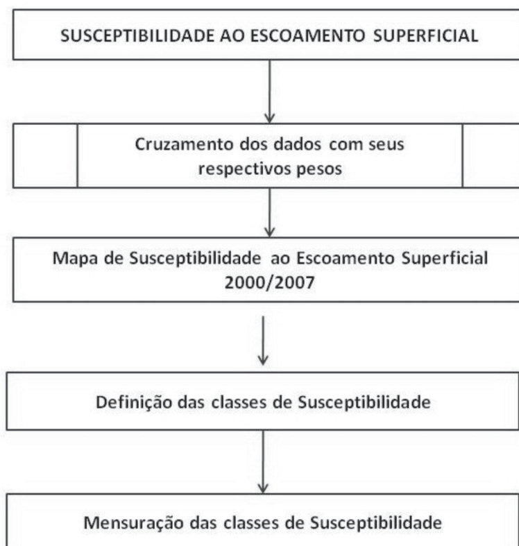
FIGURA 3. Fluxo para mensuração da susceptibilidade ao escoamento superficial.
