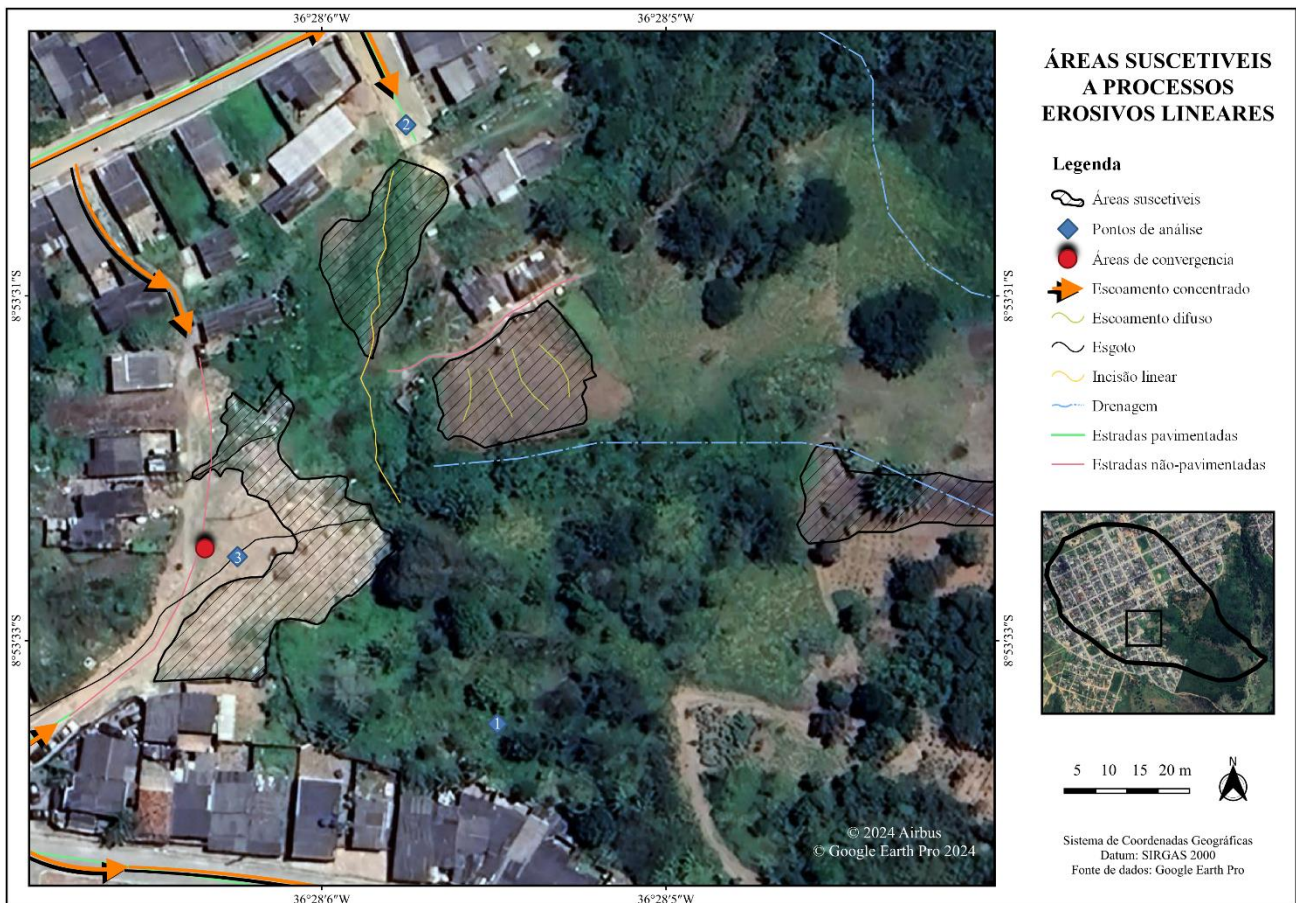
Figura 4. Áreas com suscetibilidade ao desenvolvimento de erosão linear; nota-se o início de um ravina próximo ao ponto 2 na imagem alcançando grandes dimensões espaciais. Elaboração: autor.
