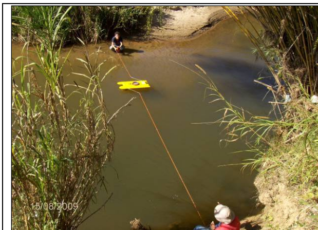
Figura 3. Foto Seção ÁGUA LIMPA – Utilização do Qliner. Autor: Carlos Renato Marcondes, Ago. 2009.
